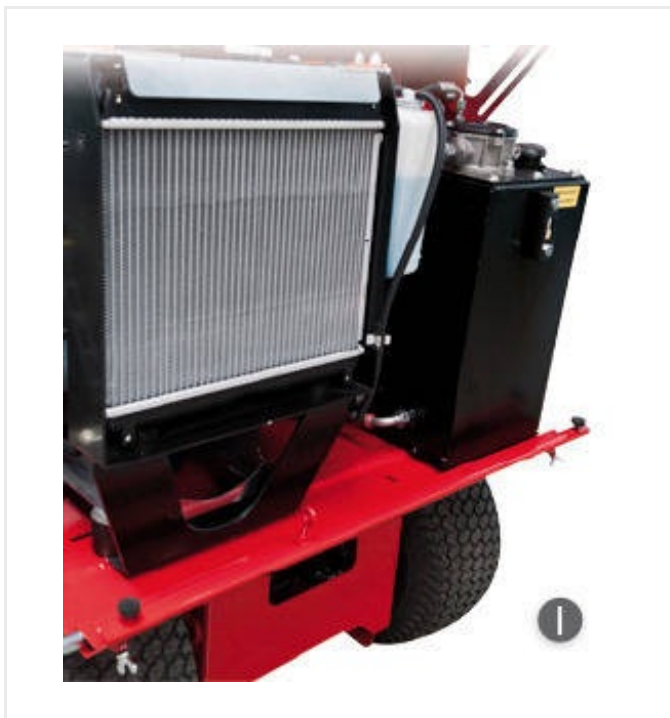
Motor diesel refrigerado por agua y unidad hidráulica
